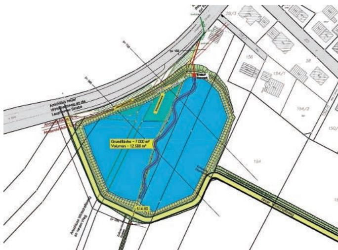
Das Hochwasser-Rückhaltebecken am Hochstetter Graben in der Dimensionierung für HQ1000.
